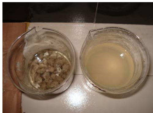
左邊風乾後的污泥餅、放入污水原水中處理後的污泥餅也有淨化的功能。 右邊是原水。
