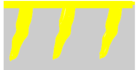
由結合聚硅而形成 硅酸鹽膜，使混凝土不滲水。
